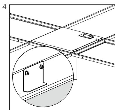
С помощью регулировочных винтов, выставить световой модуль в уровень с панелями Focus Dg.
